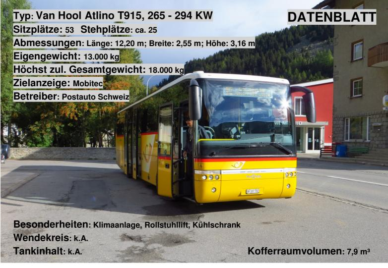
Motor: 6 Zylinder-Reihen-Dieselmotor DAF PR 265 oder MAN D2066 LOH 28 Getriebe: MB GO 210 6-Gang Schaltgetriebe oder 6 Gang Automatikgetriebe
